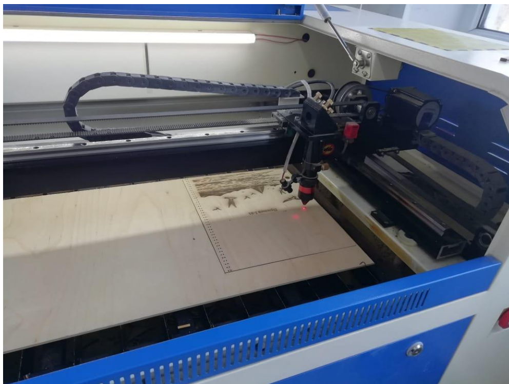
Рисунок 2 – лазерный гравировальный станок в процессе работы
